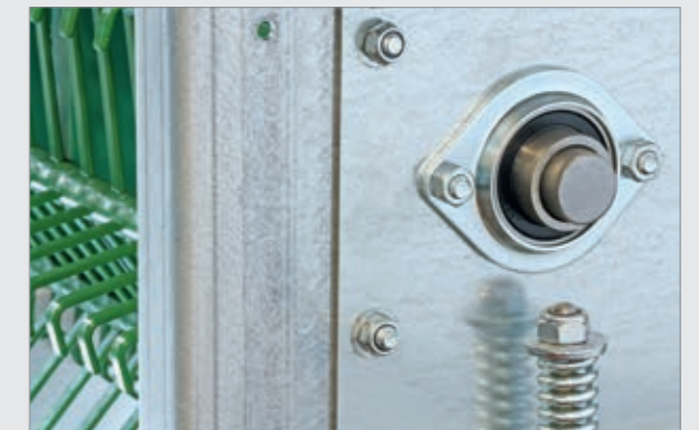
Flanschlager im Stahlblechgehäuse in einem Eierelevator
